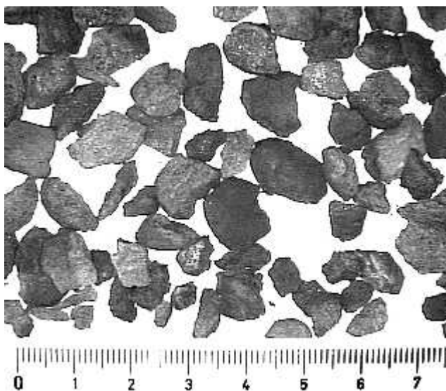
FIGURE 1.3 : Schistes pulvérisés expansés, étendue granulaire 4/9 mm
