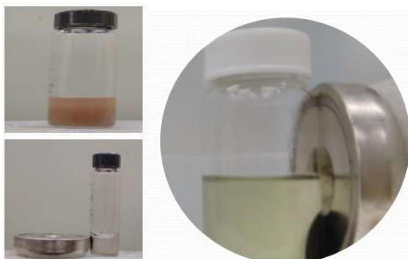
**Figure 4-10. Séparation à l'aide d'un aimant des catalyseurs de nanoparticules magnétiques.**
