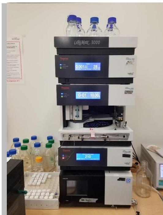
**Figure 3-2. Photo de l'appareil Ultimate 3000 Dionex de chromatographie en phase liquide (UHPLC) dans le laboratoire de catalyse Université Laval.**
