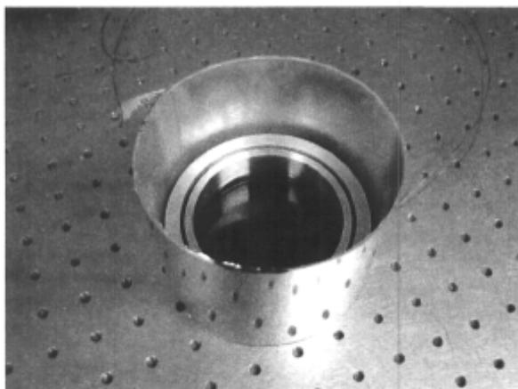
**Figure 4.6** – *Le MDF avec son contenant de ferrofluide encerclé par un cylindre de blindage magnétique en mumétal.*
