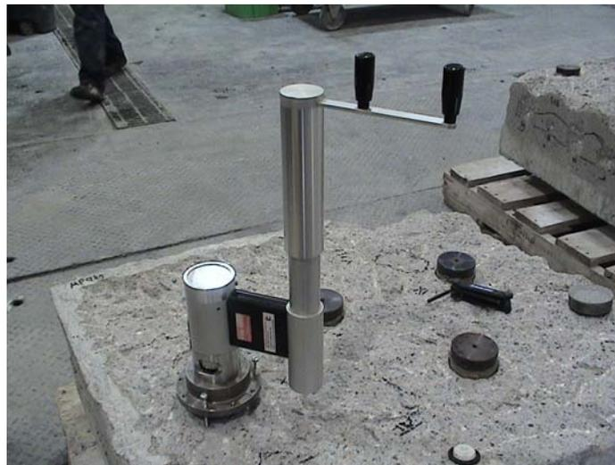
Figure 3.4 – Appareil portatif de chargement en traction
