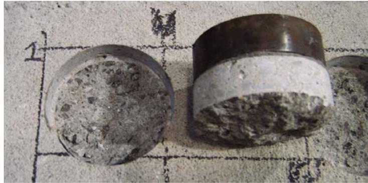
Figure 4.5 – Surface de rupture type avec le béton C3
