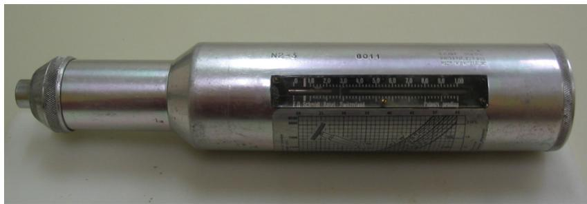
Figure 2.10 – Essai au marteau Schmidt
