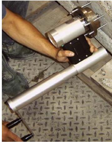
a) Appareil portatif de chargement en traction
