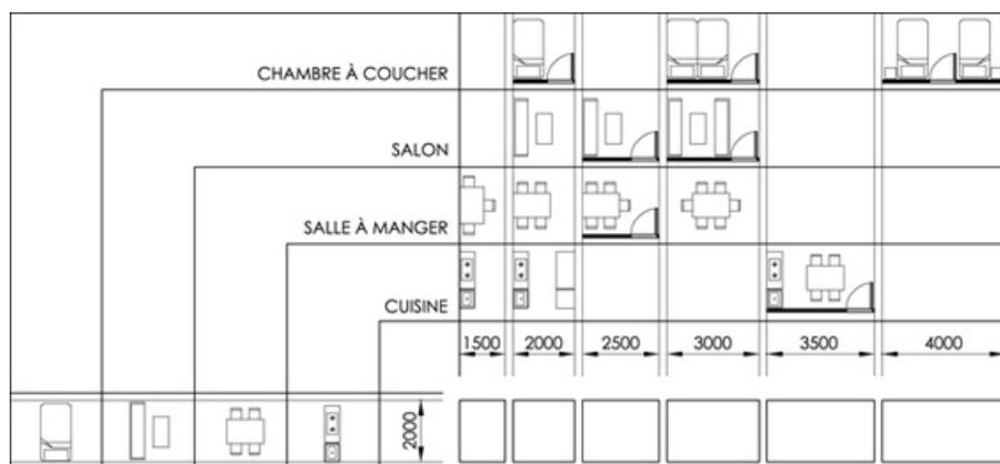
Figure 2.2.5 : Exemples de configurations de meubles selon les dimensions d'une pièce de profondeur de deux mètres (d'après Habraken, 1976)
