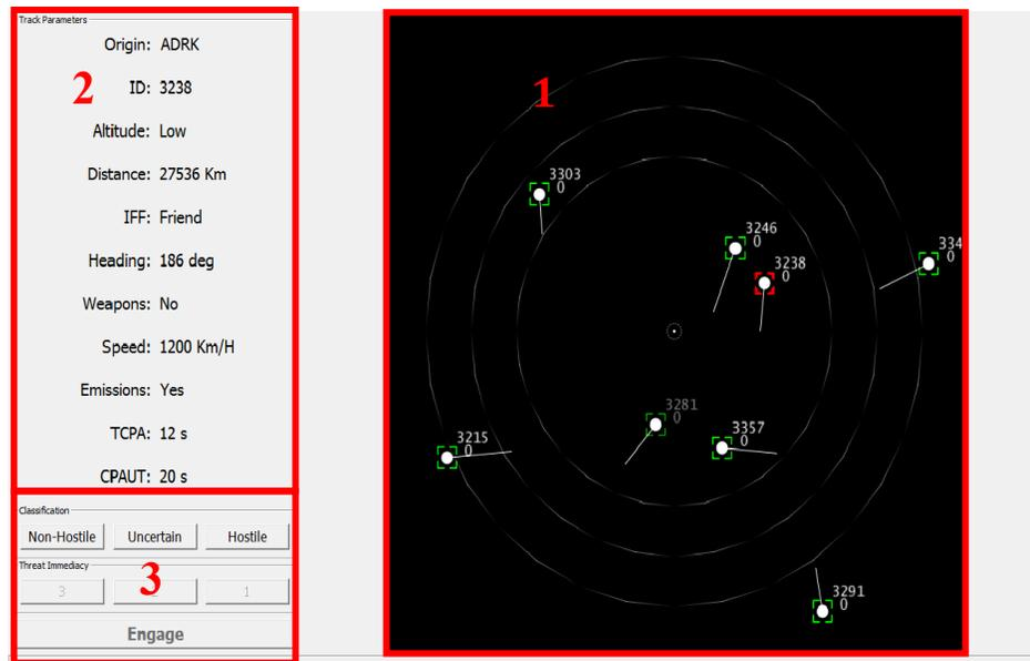
Figure 13. Interface S-CCS. Trois zones y sont délimitées : 1) l'écran radar, 2) la liste des paramètres et 3) les boutons d'action.
