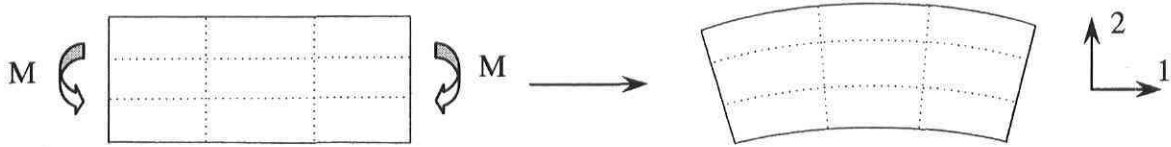
Figure 3-2 : Déformation d'un élément de matière soumis à un moment de flexion pure
