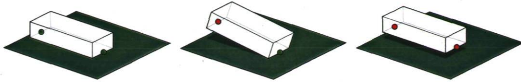
FIGURE 3.9 – Illustration de deux points de contact sur le pied d'un personnage. Ces points permettent notamment de contrôler différentes parties du pied de façon indépendante, particulièrement quant aux temps de contact. Ainsi, il est possible de permettre au talon de quitter le sol tout en forçant la pointe du pied à rester au sol.
