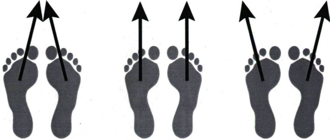
FIGURE 4.4 – Trois paires de forces différentes dont la somme est égale. Bien qu'elles soient issues de différents efforts musculaires du personnage, leur effet net sur la variation de la quantité de mouvement et du moment angulaire du personnage est identique.
