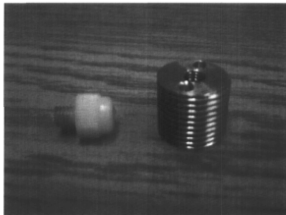
Figure 3.7 : Cylindre fileté avec un trou percé en V et au centre utilisé avec une vis de téflon percé au centre
