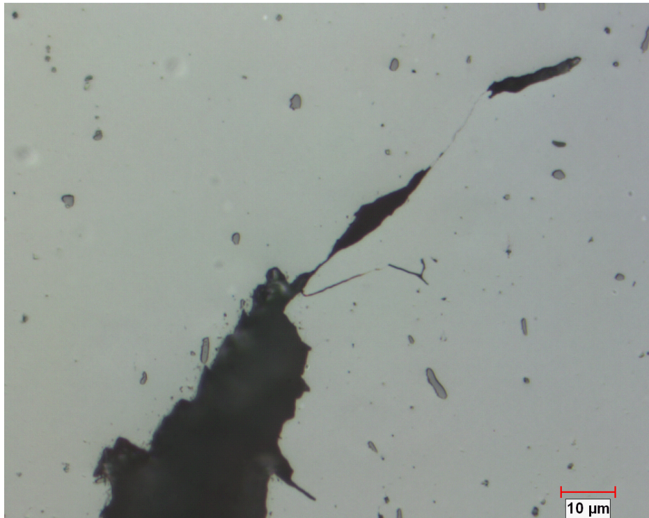
Figure 4.26 - Détails de la pointe de la fissure comportant des porosités issues de la décohésion de particules
