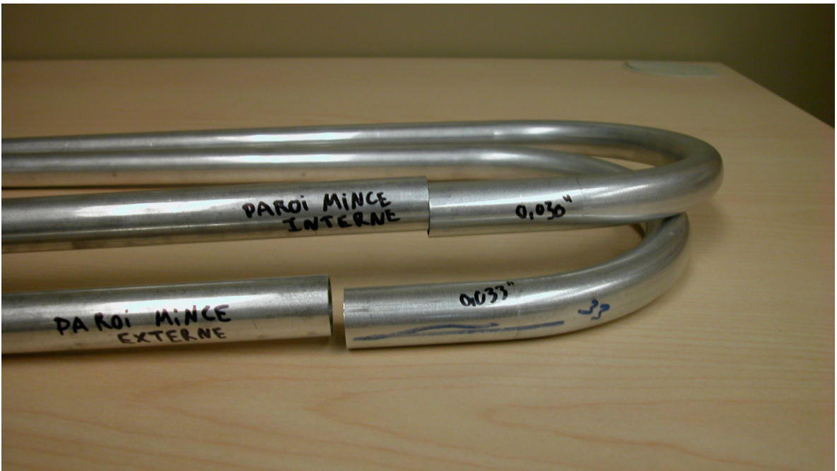
Figure 4.14 -Retour élastique non uniforme d'une raquette selon la position angulaire de la paroi mince
