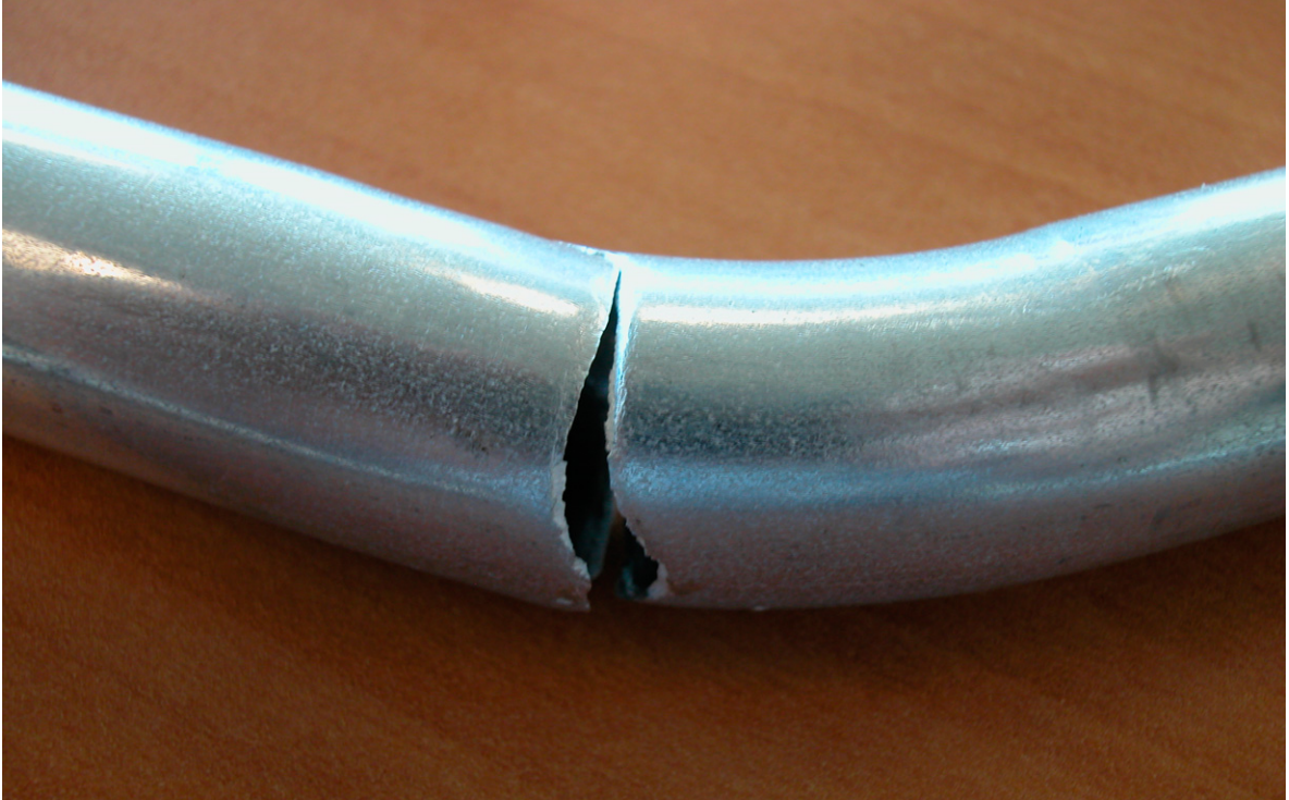
Figure 4.15 - Rupture de tube lors du pliage
