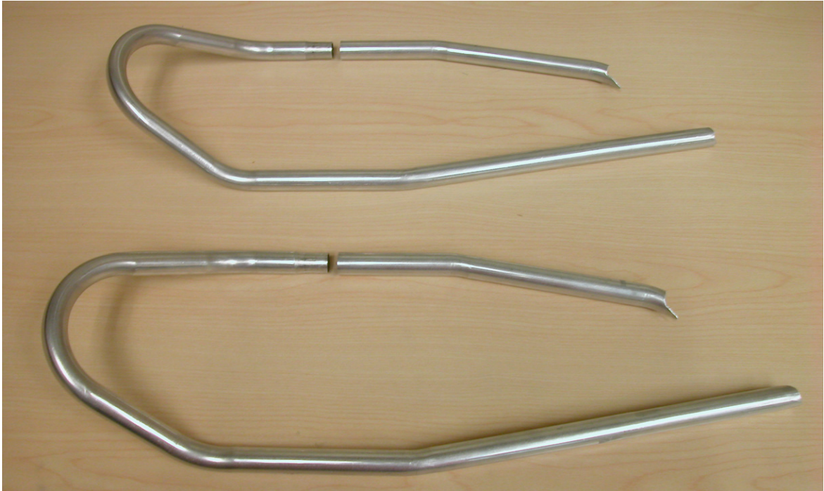
Figure 4.20 - Ruptures des tubes survenant au dernier pli de la raquette
