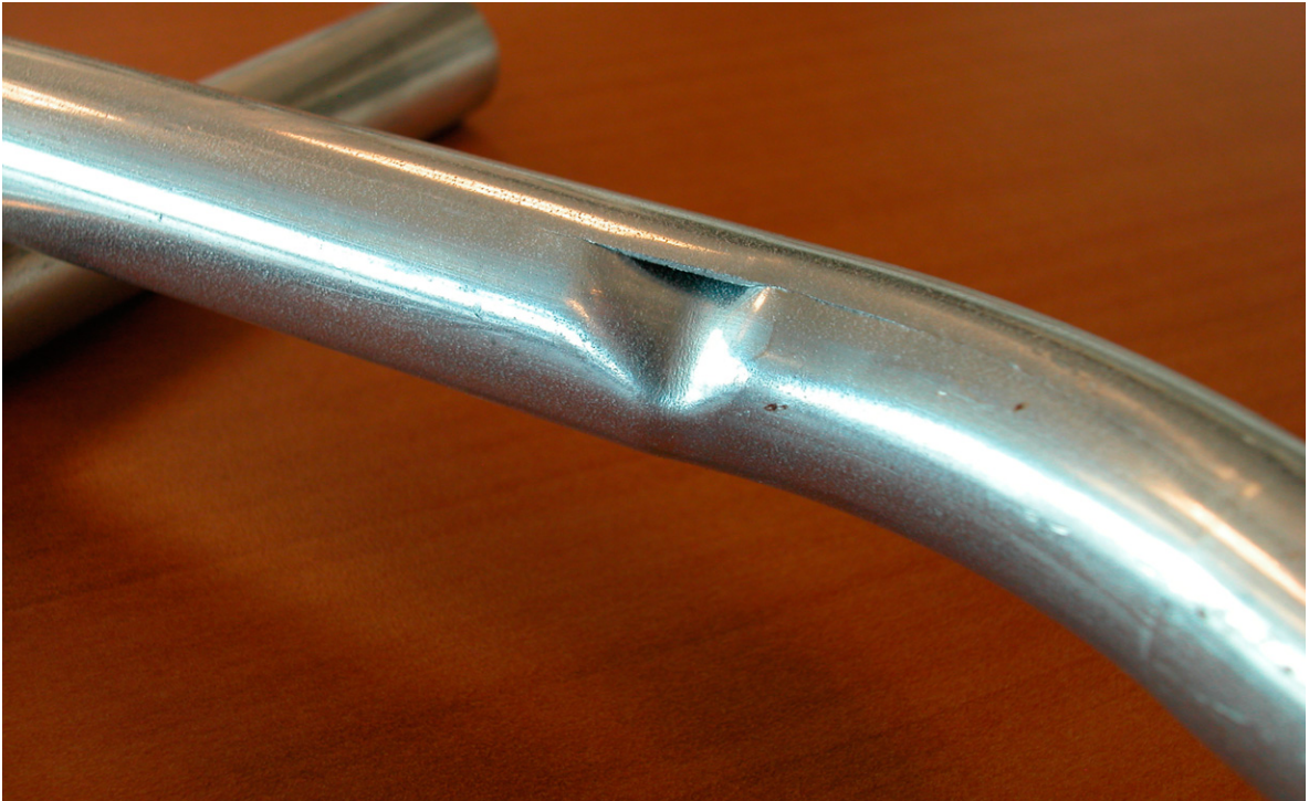
Figure 4.16 - Déchirement le long d'un segment d'extrusion lors du pliage
