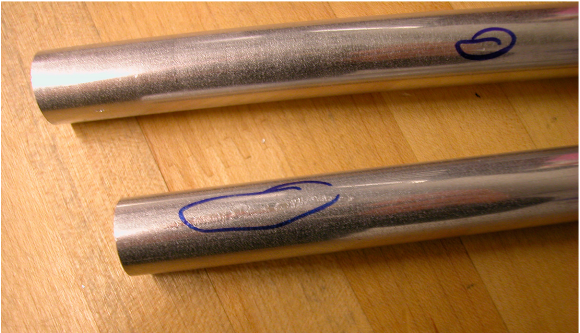
Figure 4.13 - Incrustation de copeaux à la deuxième passe d'étirage
