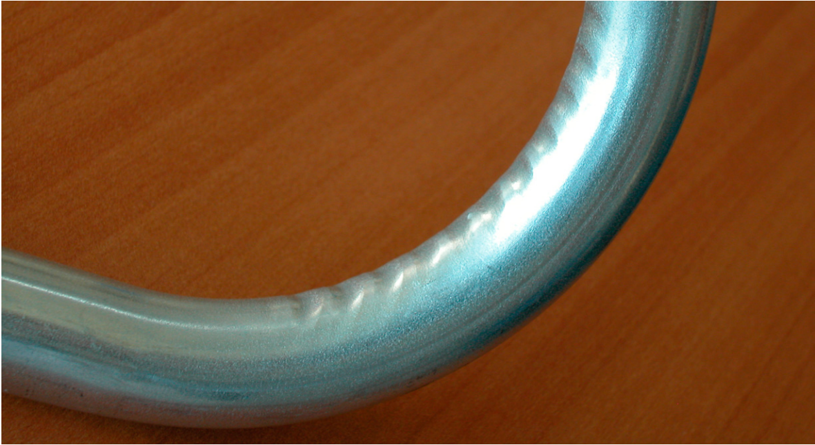
Figure 4.17 - Plissage de la paroi interne
