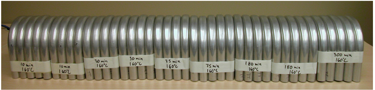
Figure 4.9 - Tubes de 6063-F traités à 160°C et pliés
