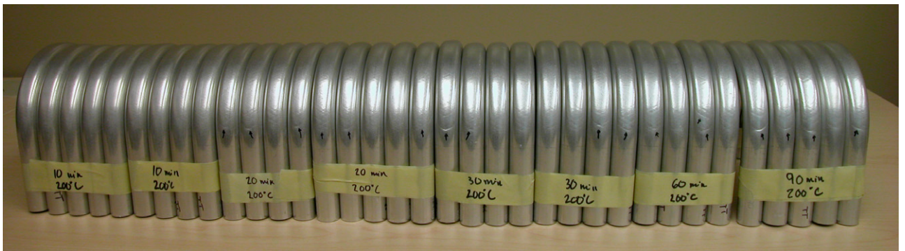
Figure 4.9 - Tubes de 6063-F traités à 160°C et pliés
