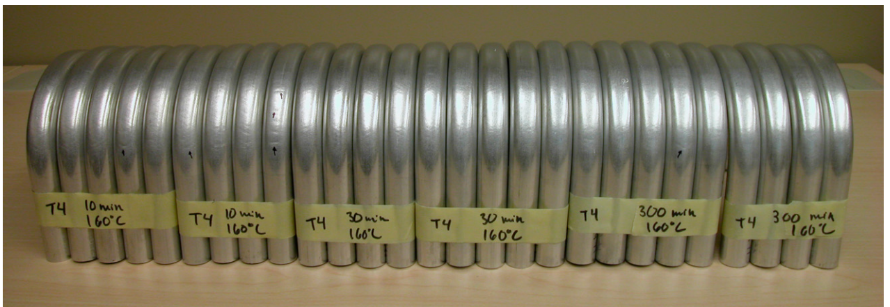
Figure 4.11 - Tubes de 6063-T4 traités à 160°C et pliés
