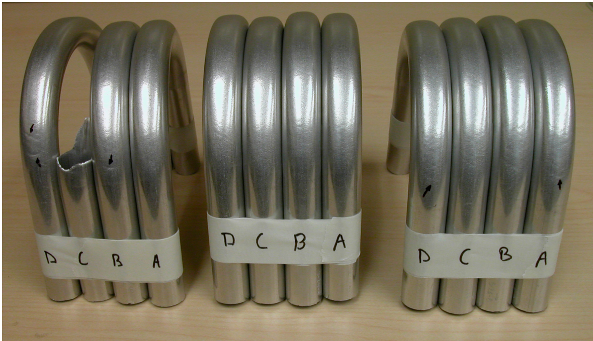
Figure 4.21 - Éprouvettes pliées prises à partir de tubes cassés 13
