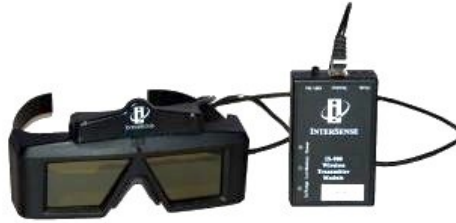
Figure 24 — Paire de lunettes stéréoscopiques avec traqueur InterSense IS-900
