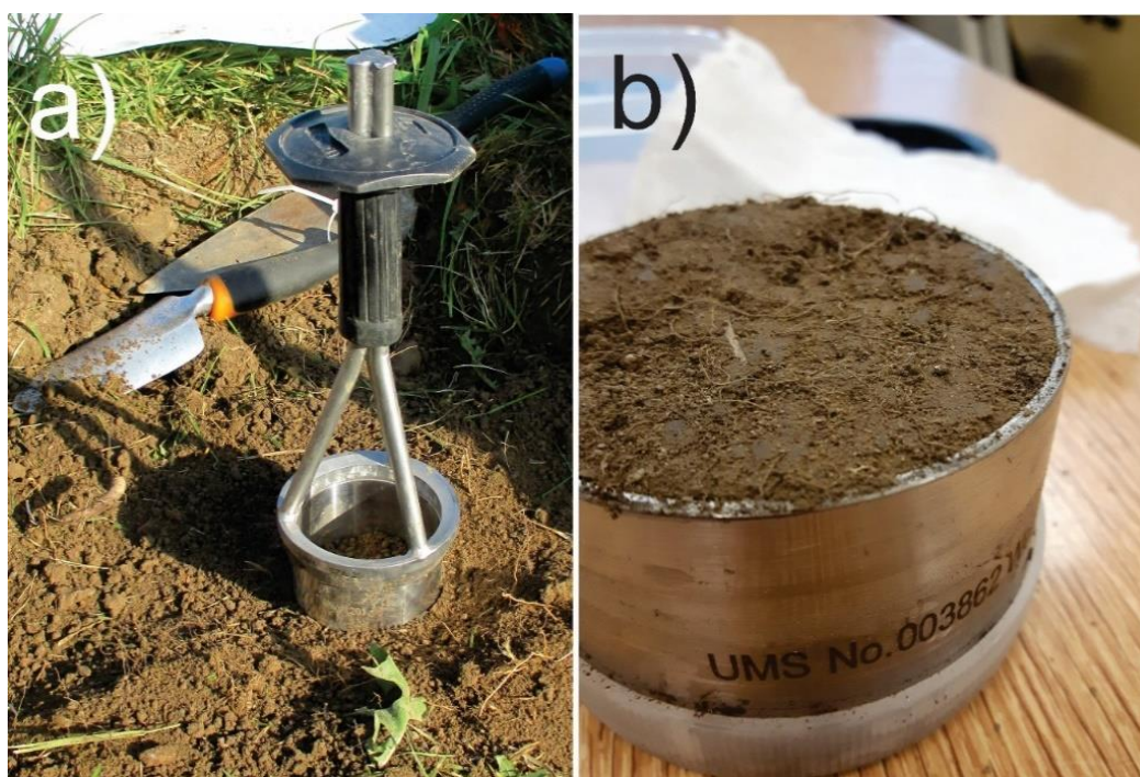
Figure 23. Photo de l'échantillonnage du sol de la zone non saturée. a) Prise d'échantillon sur le terrain. b) Échantillon de sol dans la zone racinaire.
