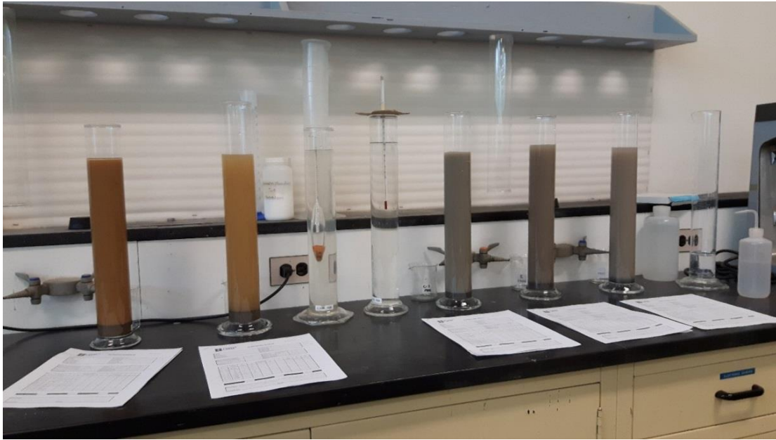
Figure 22. Photo du montage des essais de sédimentométrie en laboratoire sur les échantillons d'argile.
