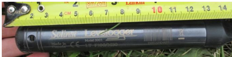
Figure 18. Photo d'une sonde de niveau d'eau Solinst utilisée dans un des puits hydrauliques.
