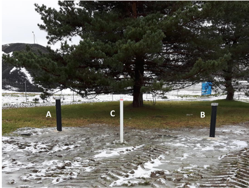
Figure 17. Photo des puits hydrauliques A, B et C à l'emplacement 27216.
