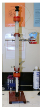
Figure 4.3. Colonne de chromatographie utilisée pour purifier les nanoparticules de silice mésoporeuses des ions de Gd^{3+} et de ^{64}Cu^{2+} résiduels (modèle XK-26/40).
