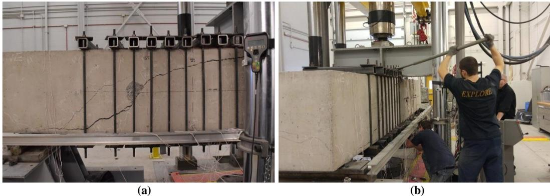
Figure 3-18. (a) Étriers externes installés sur une portée de dalle le long de la fissure de rupture ; (b) Serrage des étriers à l'aide de clés et de bras de levier
