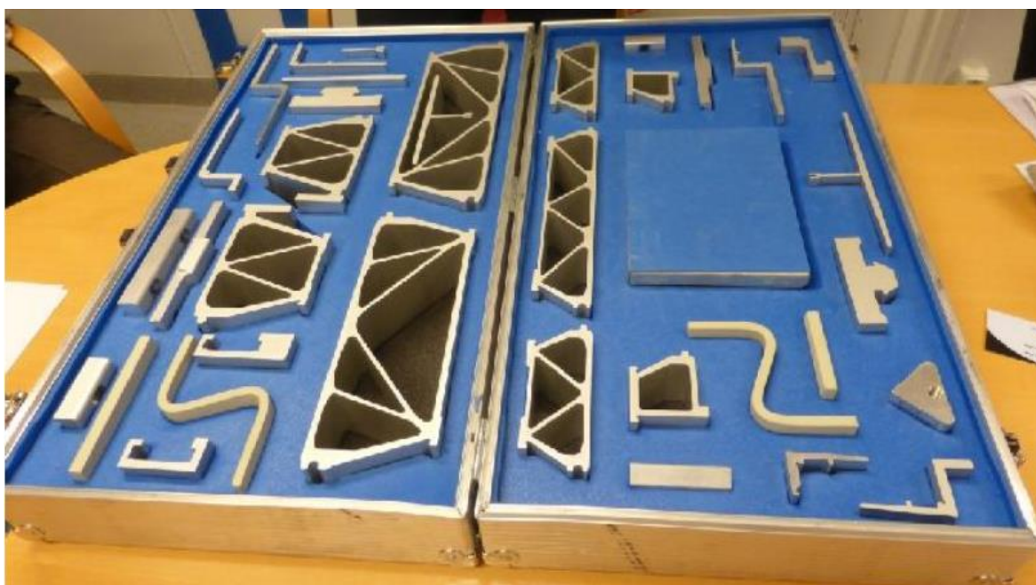
Figure 2.4 : Présentation des différentes extrusions disponibles pour l'utilisation comme platelage, tirée de Beaulieu et col. (2015)
