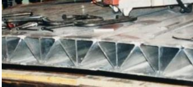
Figure 2.6 : Photographie de l'extrusion développée par Reynolds Metals, tirée de Osberg et Vachon (2014)
