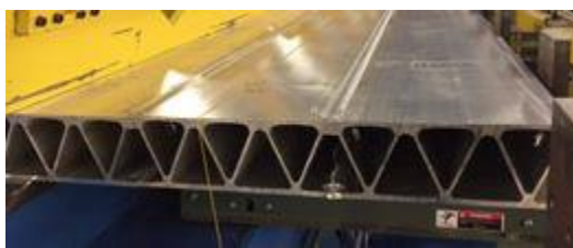
Figure 2.7 : Photographie montrant le profilé de 5 pouces d'Alumabridge, tirée de Beaulieu et col. (2015)
