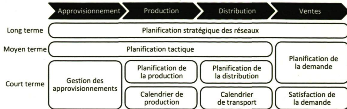
FIG. 2.1: Modules logiciels pour la planification d'une chaîne d'approvisionnement (Traduit de Meyr et al, 2002, p. 99)
