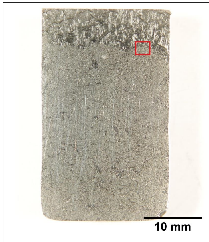
Figure 3-2 : Macrographie de l'échantillon d'alliage expérimental d'Al-Fe solidifié lentement et sédimenté naturellement. L'encadré en rouge présente le lieu approximatif de la Figure 3-3.
