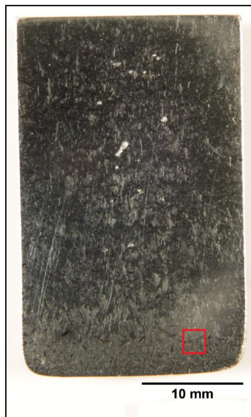
Figure 3-6 : Macrographie de l'échantillon d'alliage expérimental d'Al-Fe-Si solidifié lentement et sédimenté naturellement. L'encadré en rouge présente le lieu approximatif de la Figure 3-7.
