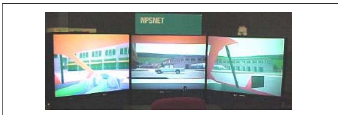
Figure 23: Expérience de Bernatovitch (2000). EV non immersif comportant trois écrans permettant aux participants d'avoir un champ de vision horizontal de 133 degrés. Les hauts parleurs sont placés derrière le sujet.
