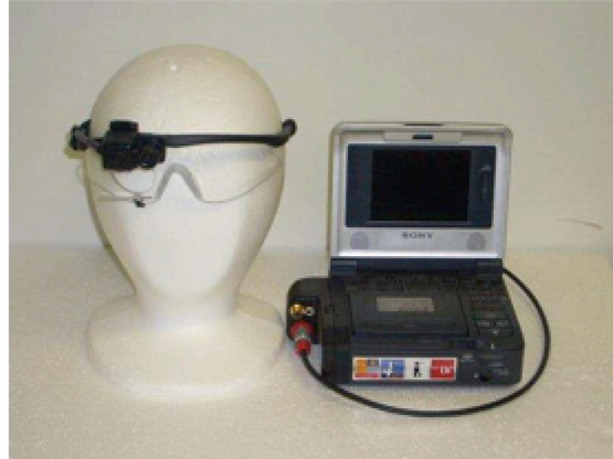
Figure 23 : Le système Mobile Eye et son enregistreur vidéo
