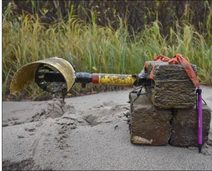
*Figure 6. Configuration pour l'installation des turbidimètres lors de l'été 2019. Les turbidimètres étaient installés sur des blocs de béton et déposés sur le lit de la rivière.*
