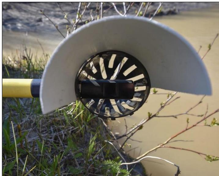
Figure 5. Configuration pour l'installation des turbidimètres lors de l'été 2019. Le grillage en noir limite l'accumulation de matières organiques provenant de l'amont et le plastique blanc limite l'influence que peut occasionner le rayonnement solaire direct.
