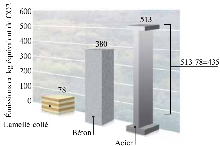
FIGURE 1.15 – Potentiel de réchauffement climatique d'une poutre analysé avec le logiciel ATHENA TM [26]
