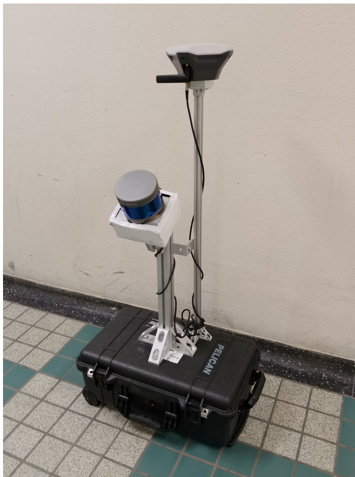
FIGURE 3.1 – Plate-forme finale : structure extérieure. Le récepteur GNSS est positionné le plus haut pour réduire les interférences. Le lidar est mis en angle pour permettre de voir les obstacles pour le récepteur.
