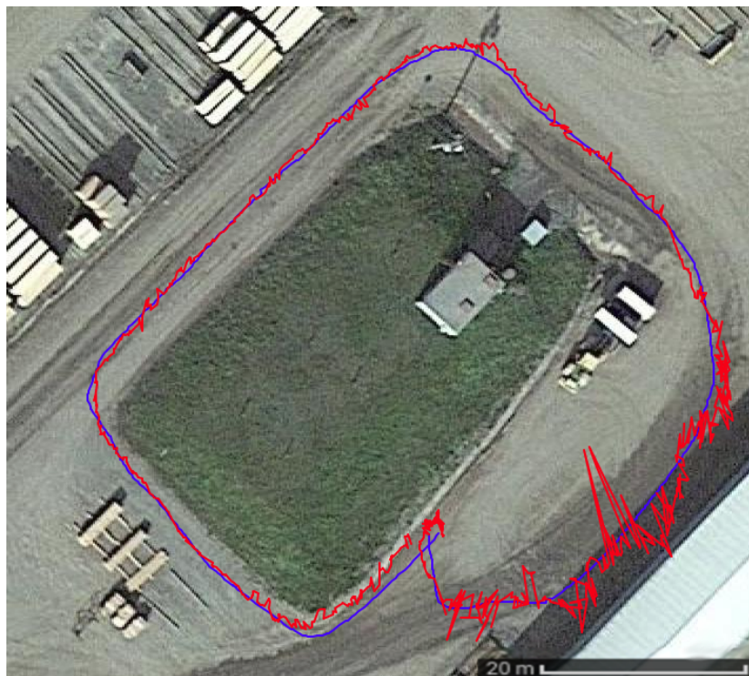
FIGURE 4.4 – Résultat de trajectoire avec (en bleu) et sans (en rouge) correction. Notez les très grands écarts de position pour la trajectoire non corrigée.
