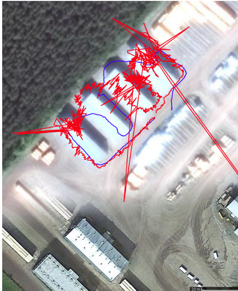
FIGURE 4.8 – Résultat de trajectoire obstruée avec et sans correction. Bleu : avec correction. Rouge : sans correction
