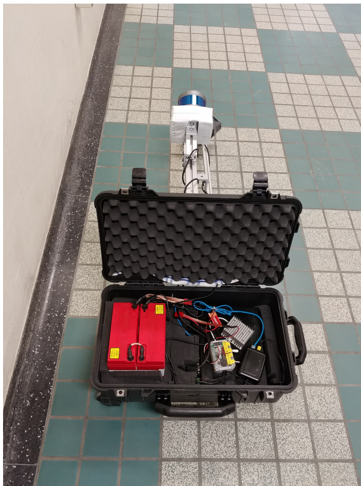
FIGURE 3.2 – Plate-forme finale : structure intérieure. La batterie rouge occupe une bonne partie de la boîte. On peut voir l'électronique et l'ordinateur à droite.
