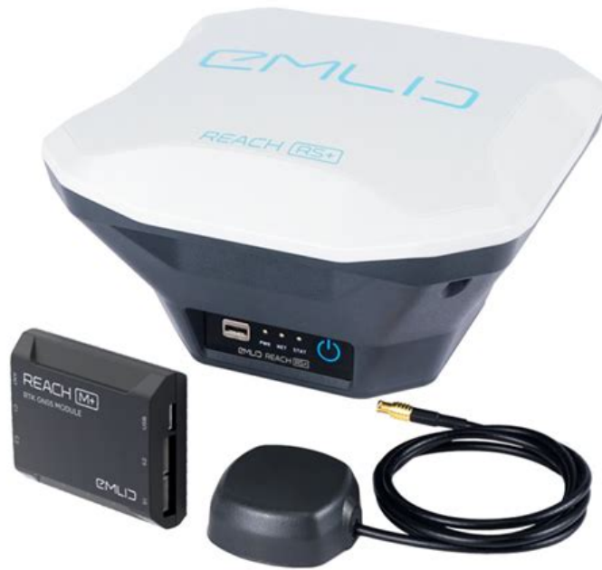
FIGURE 1.5 – Solution complète RTK. Dans la photo, on peut voir les deux principaux éléments. Le plus gros boîtier est le Reach RS , qui est la station de référence. Le plus petit boîtier est le Reach M+ , qui est le module mobile.
