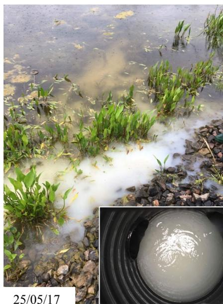
**Figure 48 - Écoulement blanchâtre**
