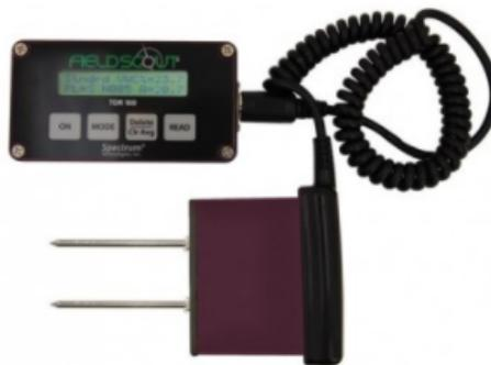
**Figure 17 - TDR 100 Appareil de mesure de l'humidité du sol**
