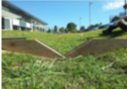
**Figure 3 - Exemple de déversoir en V (Lucke et al., 2014)**
