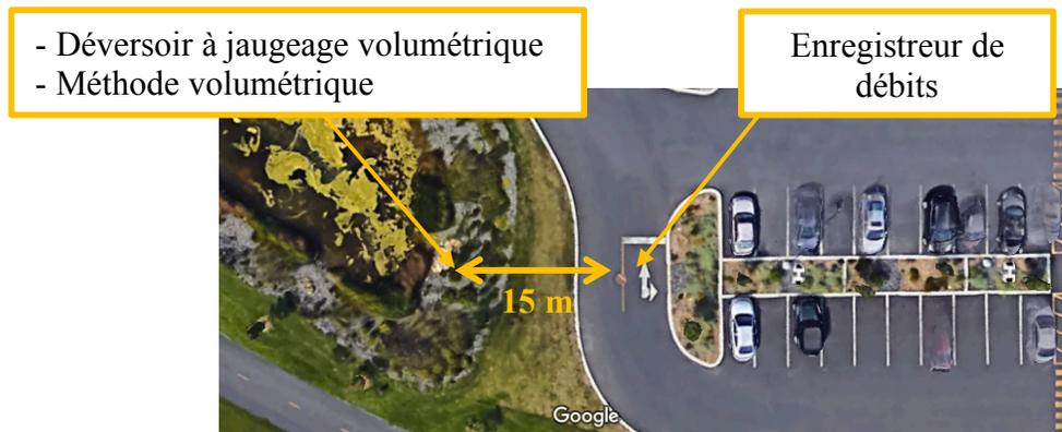
**Figure 34 – Points de mesure de débits**
