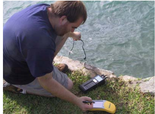
Figure 20 : Manipulation du GeoXM et d'un thermomètre lors de l'échantillonnage d'eau
