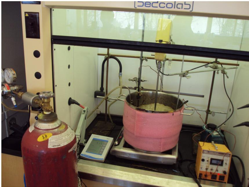
Figure 2.1 : Système de précipitation de la lignine Wayagamack par CO<sub>2</sub> à partir de la liqueur noire
