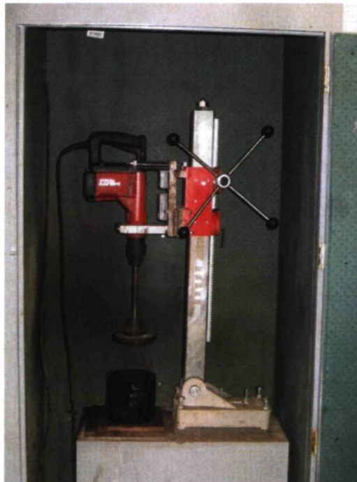
Figure 3.1 : Montage pour la réalisation des échantillons pour les essais du module réversible modifié et de la capacité portante.
