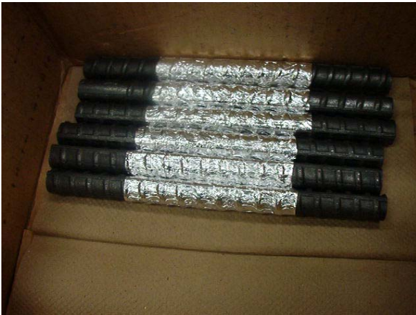
Figure 4-4 : Protection des barres avec du papier d'aluminium
