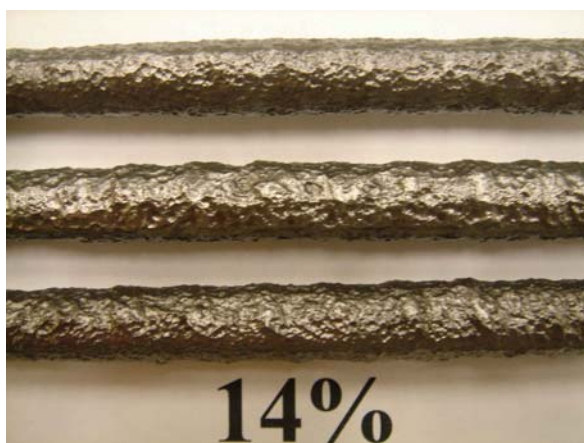
Figure 5-36 : Barres d'armature à 14 % de perte de masse
