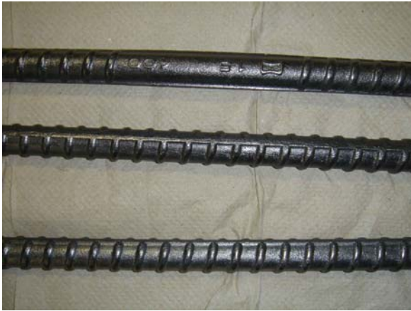
Figure 5-28 : Barres d'armature à 0 % de perte de masse
