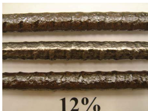
Figure 5-35 : Barres d'armature à 12 % de perte de masse
