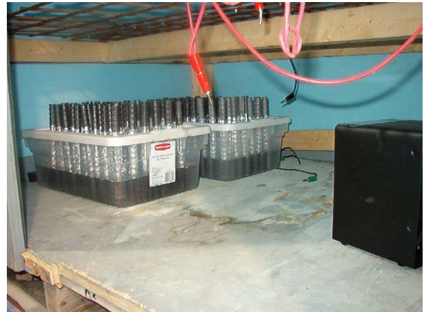
Figure 4-5 : Traitement des barres au NaOH
