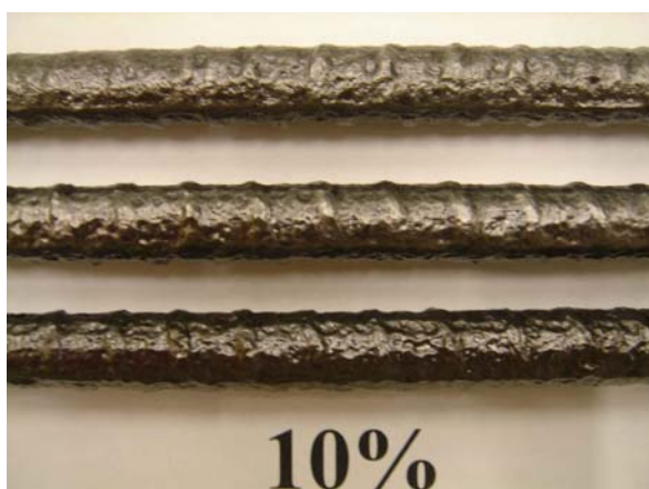
Figure 5-34 : Barres d'armature à 10 % de perte de masse
