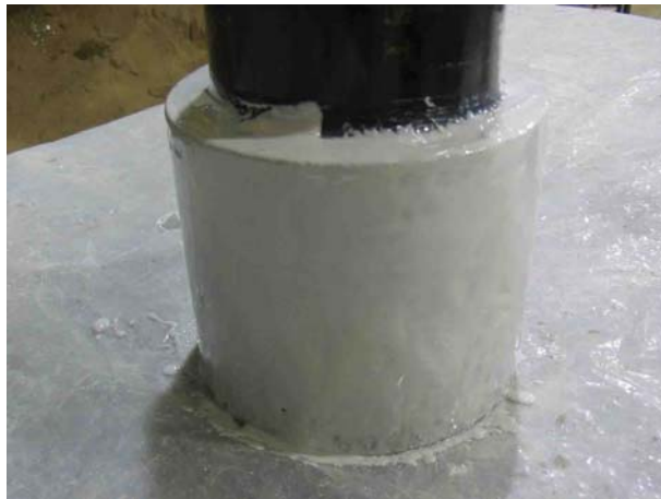
Figure 4-13 : Recouvrement d'époxy sur les éprouvettes
