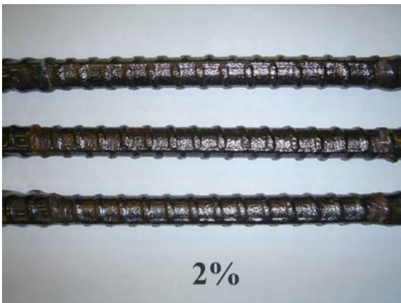
Figure 5-30 : Barres d'armature à 2 % de perte de masse
