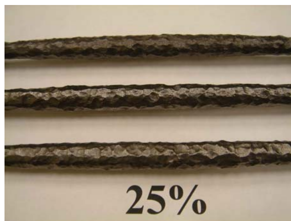
Figure 5-37 : Barres d'armature à 25 % de perte de masse
