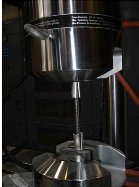
Figure 4-26 : Montage pour essai de traction
