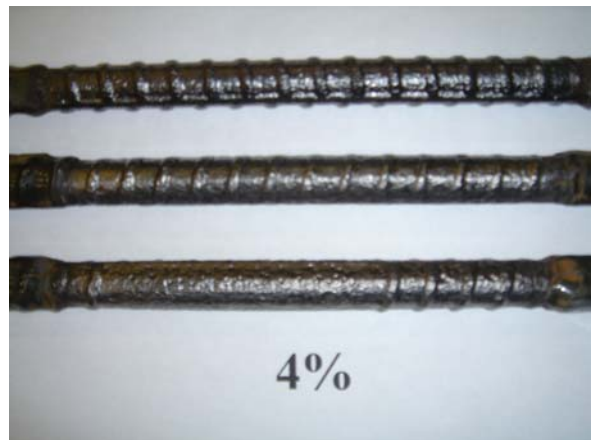
Figure 5-31 : Barres d'armature à 4 % de perte de masse
