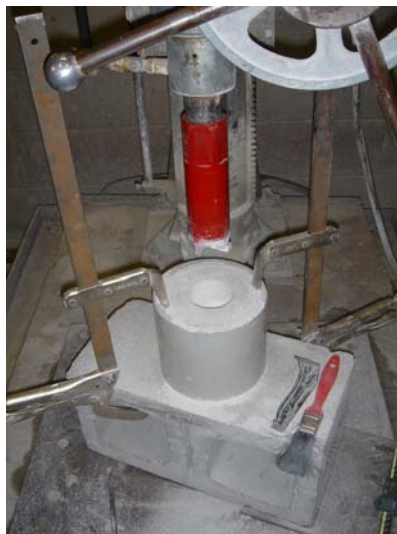
Figure 4-18 : Montage pour le broyage
