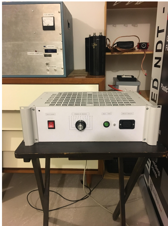
FIGURE 3.9 – Système de Chauffage par induction.
