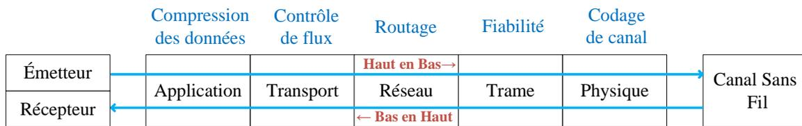
FIGURE 2.5 – Architecture de protocole en couches.
