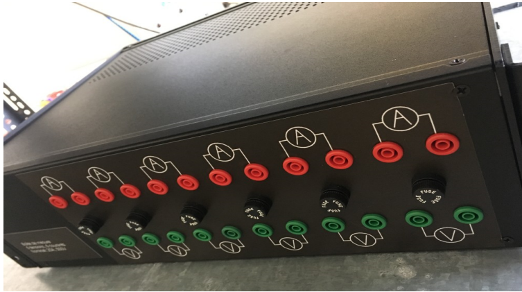
FIGURE 3.6 – Photo de la boîte d'instrumentation isolée
