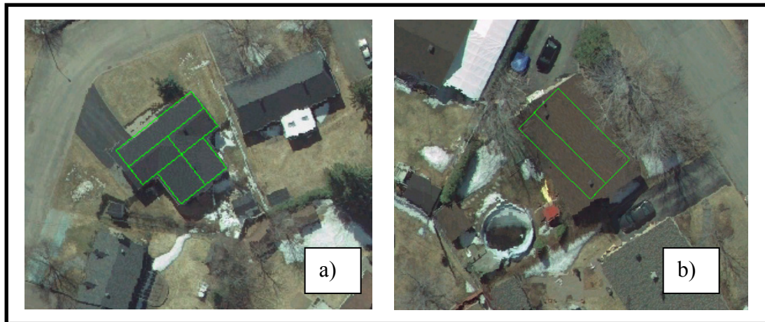
Figure 35 : Exemple de résultats obtenus automatiquement. a) extraction réussie b) échec dans l'extraction de l'orientation du bâtiment.
