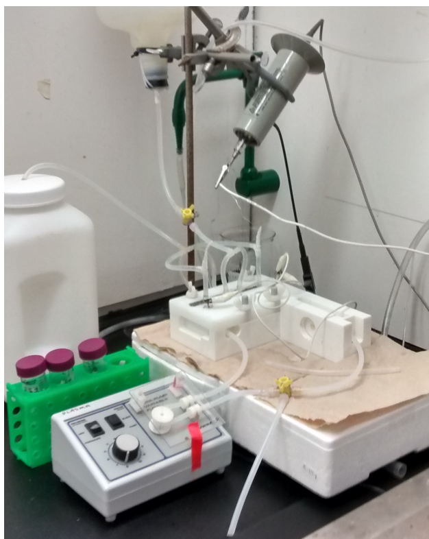
Figure 2.2. Vue d'ensemble du système de traitement plasma.
