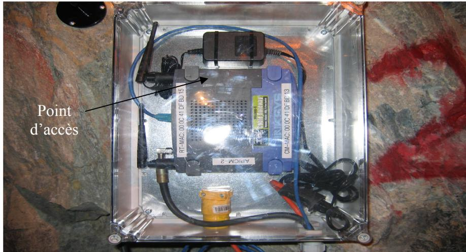
Figure 2.9 Point d'accès installé dans une galerie de mine.
