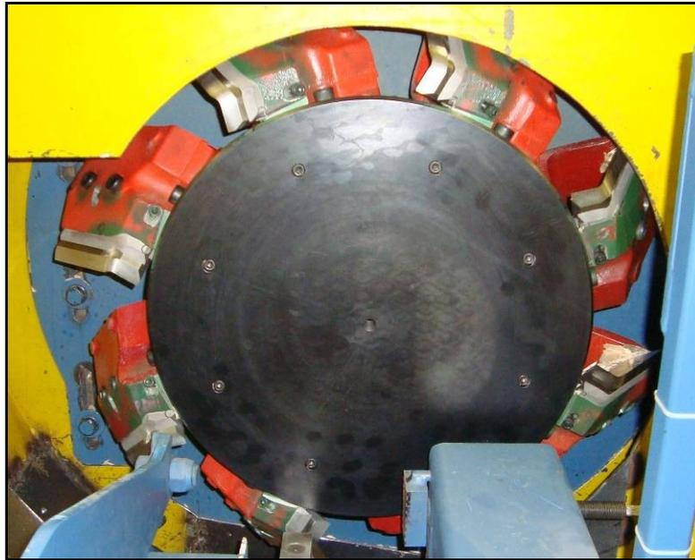
**Figure 1.10.** Tête porte-outils de l'équarrisseuse-fragmenteuse Comact, munie de 8 porte-couteaux.
