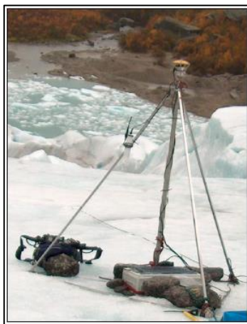
Figure 11. Installation de la station de base dans le glacier
