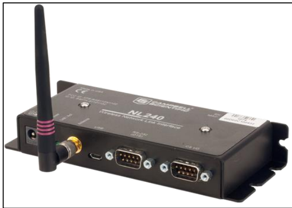
Figure 22. NL240 et antenne Wi-Fi.
