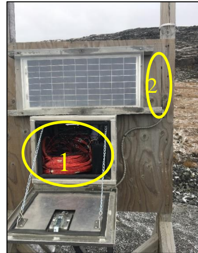
Figure 29. Vue de la ST-B. 1. Système d'acquisition de données, 2. Antenne Wi-Fi.
