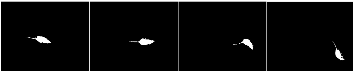
Figure 4.9 – La souris blanche dans la cage grise après la soustraction d'arrière-plan avec l'algorithme MOG. La caméra est placée sur le dessus de la cage. La vidéo est hors ligne [8].
