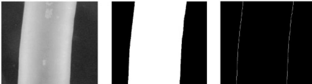
**Figure 2.11: Traitement d'images pour la mesure de diamètre**
