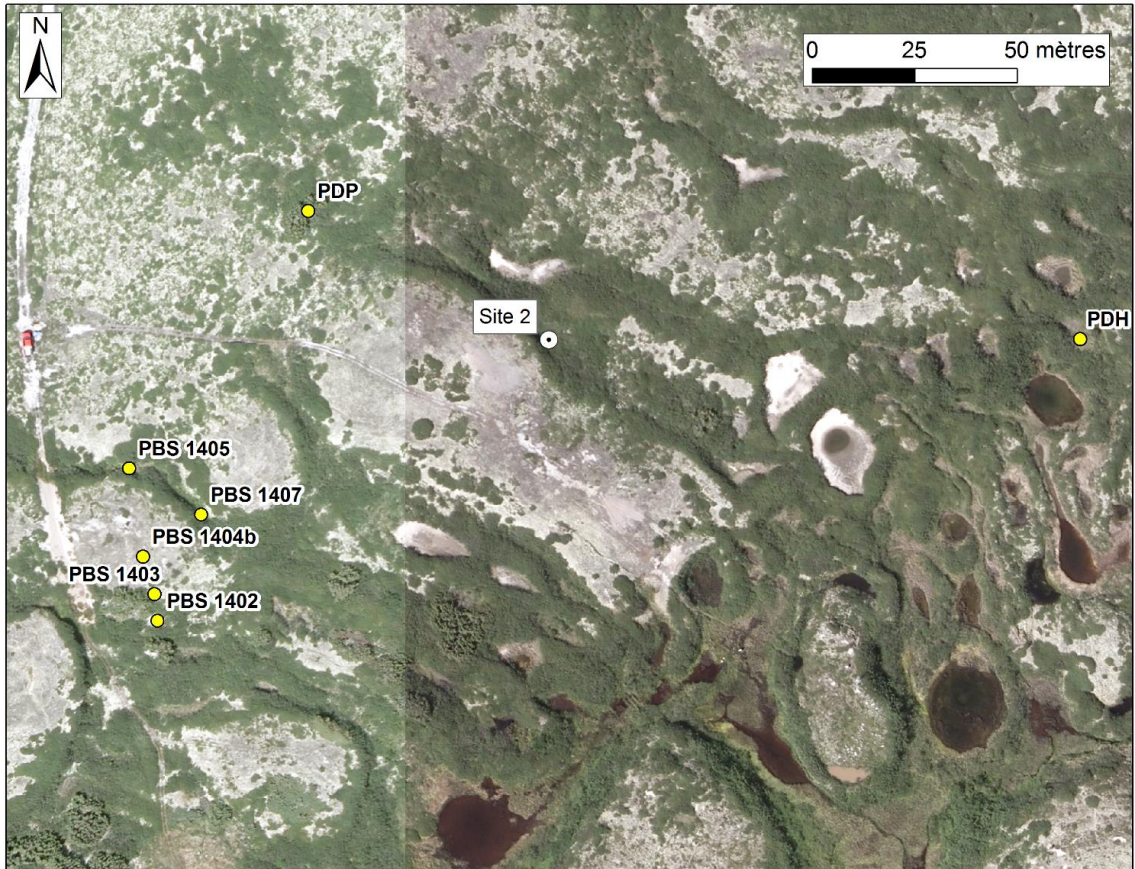
Figure 23 - Localisation des piézomètres dans l'aquifère superficiel. Dans le chapitre 3, Pz1405, Pz1404b, Pz1402 and PzDP correspondent à respectivement PBS1405, PBS1404b, PBS1402 et PDP. Les schémas d'aménagement de ces puits sont présentés dans l'annexe 4 à la suite des puits Immatsiak.
