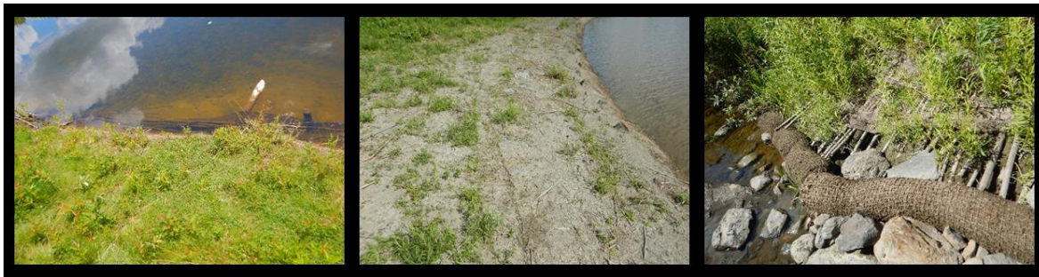
Figure 1.13. Cas potentiels d'échec rencontrés dans les ouvrages de génie végétal, intervenant surtout durant les premières années après l'implantation de l'ouvrage. De gauche à droite : arrachage de l'ouvrage par les glaces, dessèchement des végétaux, affouillement du pied de berge. Photographies : Maxime Tisserant.
