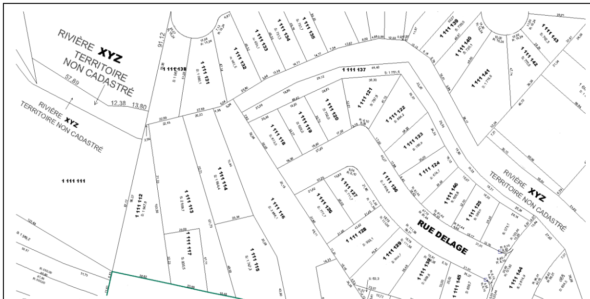
Figure 26 : Exemple d'une représentation cadastrale hétérogène d'un cours d'eau (numéros de lots fictifs) 936
