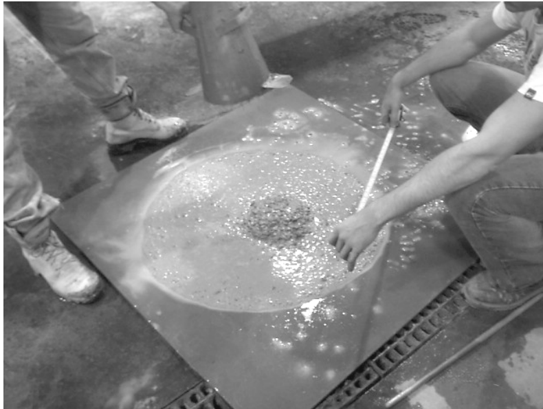
Figure 3.25 : Essai d'étalement montrant des signes de ségrégation (photo par Jonathan Boucher et Dany Blackburn, 2004)
