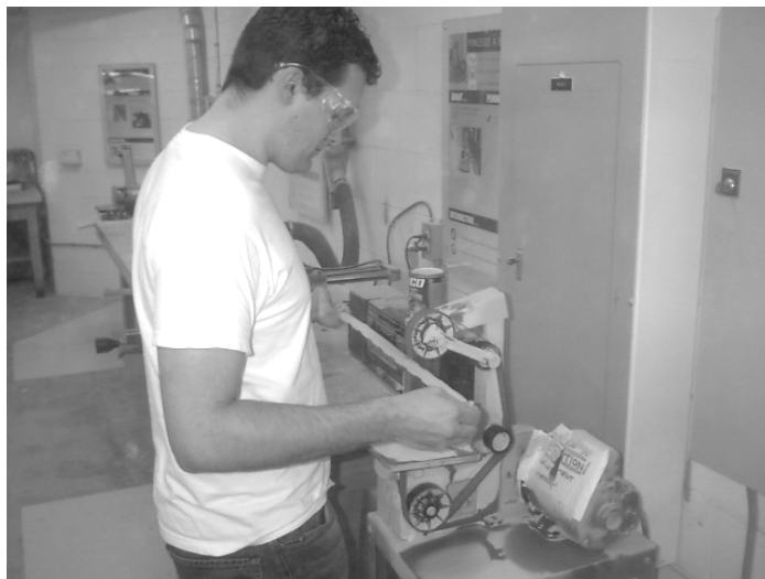
Figure 3.7 : Confection des crénelures à l'aide d'une ponceuse à ruban (photo par Jonathan Boucher, 2003)
