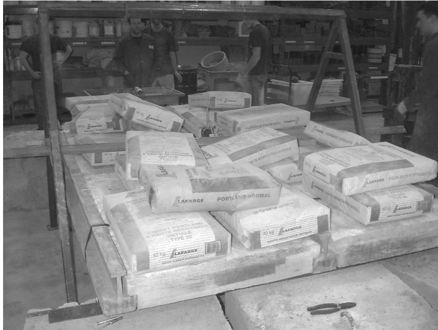
Figure 3.33 : Empilement de sacs de sable jusqu'à la charge totale admissible (photo par Jonathan Boucher et Dany Blackburn, 2005)
