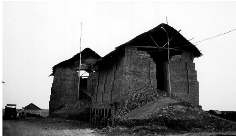
Figure 1.22 : Four à briques artisanal (photo par Jonathan Boucher et Dany Blackburn, 2002)
