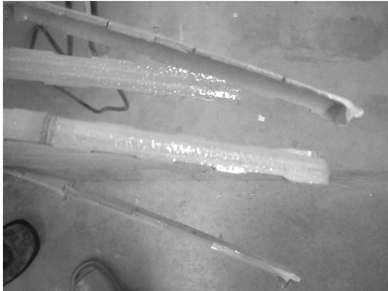
Figure 3.9 : Les armatures après les traitements d'imperméabilisation et d'amélioration de l'adhérence (photo par Jonathan Boucher, 2003)
