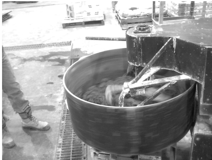
Figure 3.26 : Malaxage du béton (photo par Jonathan Boucher et Dany Blackburn, 2004)
