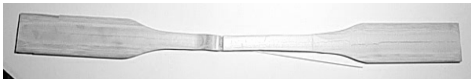
Figure 3.12 : Éprouvette de bambou après rupture (photo par Dany Blackburn, 2004)
