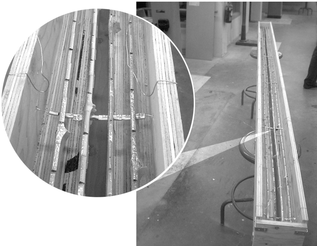
Figure 3.22 : Fixation des armatures (photo par Jonathan Boucher et Dany Blackburn, 2004)
