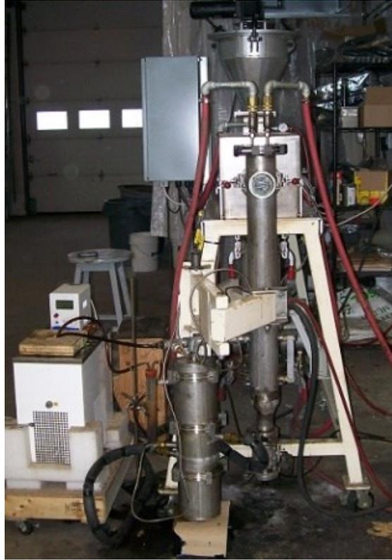
Figure 3.7 Système de collecte de l'huile pyrolytique
