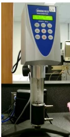
Viscosimètre rotationnel (DV-II + Pro viscometer, Brookfield)
