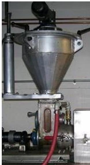
Figure 3.4 Système d'alimentation : trémie + sas
