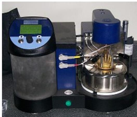
Appareil de mesure point éclair en vase clos (Multiflash Pensky, Stanhope – Seta)
