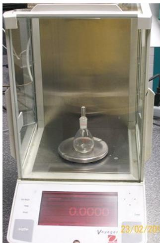
La capacité du flacon est de 25 mL. Une calibration avec de l'eau est d'abord effectuée puis vient le tour de l'huile pyrolytique.
