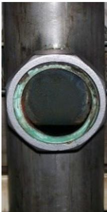
Fin de pyrolyse, absence de vapeurs de pyrolyse.
