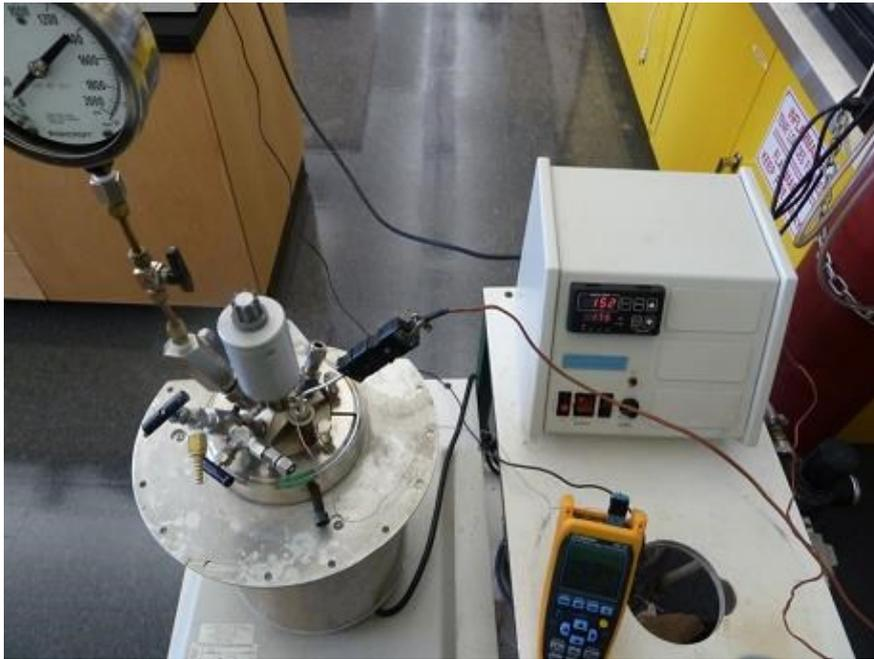
Figure 3.1 Ensemble de prétraitement : réacteur sous pression + contrôleur de température + thermocouple
