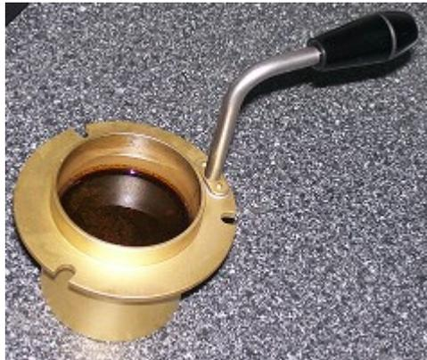
Cette cuve est ensuite portée dans l'appareil de mesure où l'huile est chauffée doucement. À intervalles réguliers, un allumeur électrique est dirigé dans la cuve afin de procéder au test d'inflammation.
