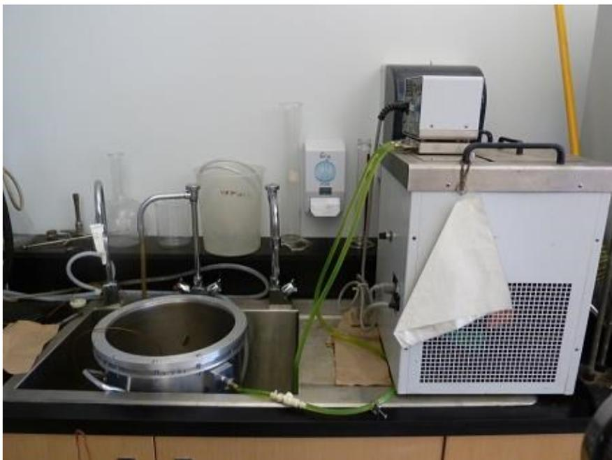
Figure 3.2 Ensemble de refroidissement : enceinte calorifique + bain réfrigérant
