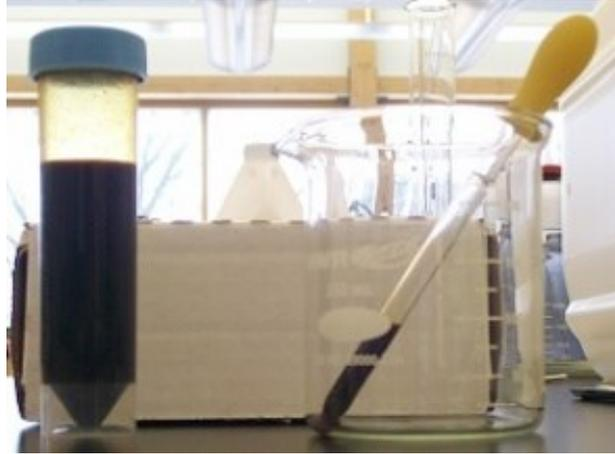
Le mélange est ensuite filtré sous vide à travers un filtre de fibre de verre de porosité 1 mm préalablement pesé. Une fois la filtration terminée, le filtre est placé à 105 °C pendant une heure puis pesé. La différence de masse correspond aux matières solides.
