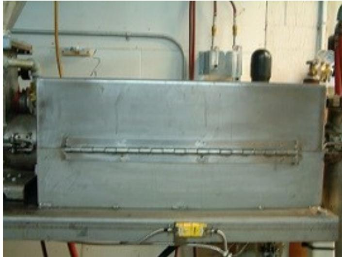
Figure 3.5 Réacteur de pyrolyse
