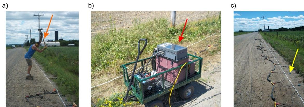
Figure 2.3: Matériel d'acquisition des données sismiques: a) une source constituée de l'impact d'une masse sur une plaque de métal en contact avec le sol, b) un sismographe Stratavisor NZ 24 de 24 canaux et c) une série de géophones plantés dans le sol et branchés à des câbles sismiques et au sismographe.
