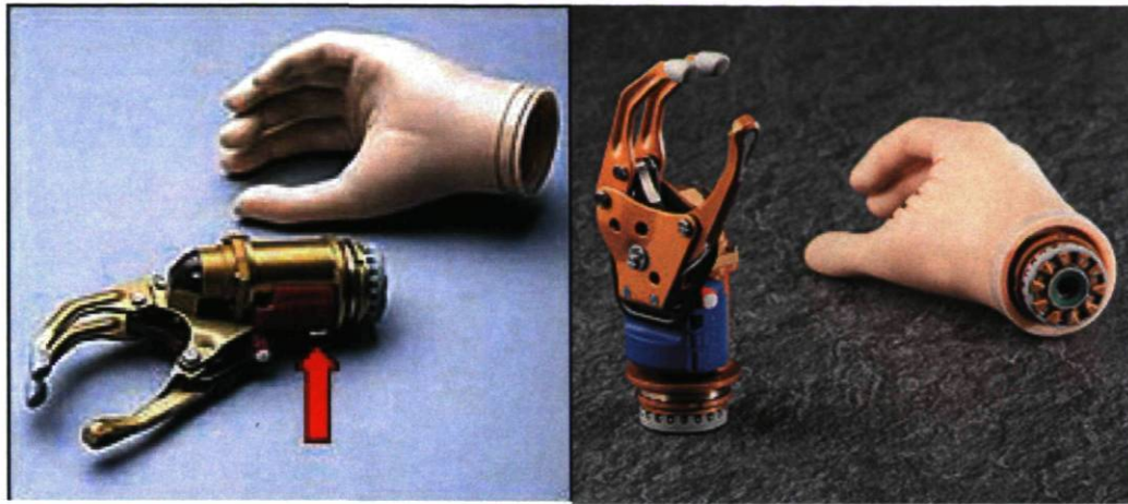
FIGURE 2.10 – La Sensor Hand d’Otto Bock avec et sans gant cosmétique (source : Otto Bock).
