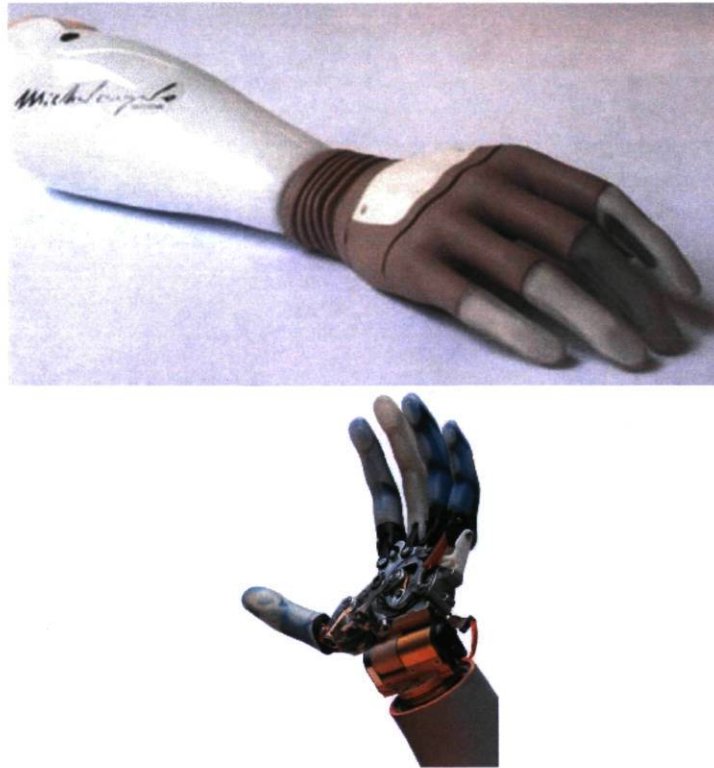
FIGURE 2.11 – La main MichelAngelo d’Otto Bock avec et sans le gant cosmétique (source : Otto Bock).
