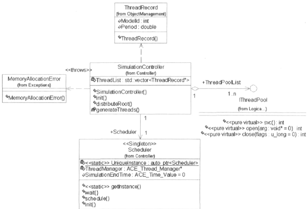
FIG. 9.2 – Diagramme de classe UML TM du contrôleur et de l'ordonnanceur
