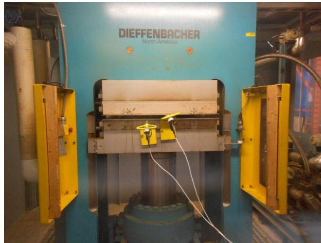
Figure 2-1 Presse utilisée dans la procédure de pressage à froid (marque Dieffenbacher, 862 mm x 862 mm)
