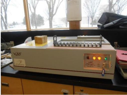
Figure 2-3 Mesure de la masse volumique des ébauches de fibres à travers l'épaisseur : a) mesure de la masse volumique par rayons X(Quintek Measurements Systems model QDP-01X, Knoxville, TN, USA); b) profil de masse volumique à travers de l'épaisseur de l'ébauche de fibres.
