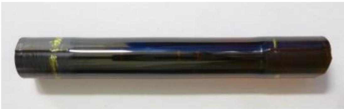
**Figure 2.1** – Photographie d'une préforme polie d'un verre 45AgI-(40)AgPO<sub>3</sub>-15WO<sub>3</sub>.
