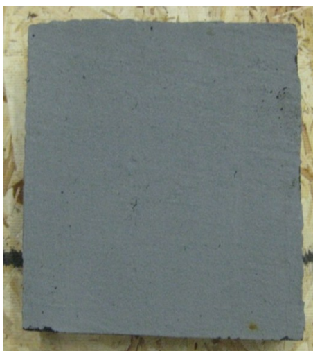
Figure 6.29: Échantillon de PerfectCool AP après 72 cycles de gel et de dégel
