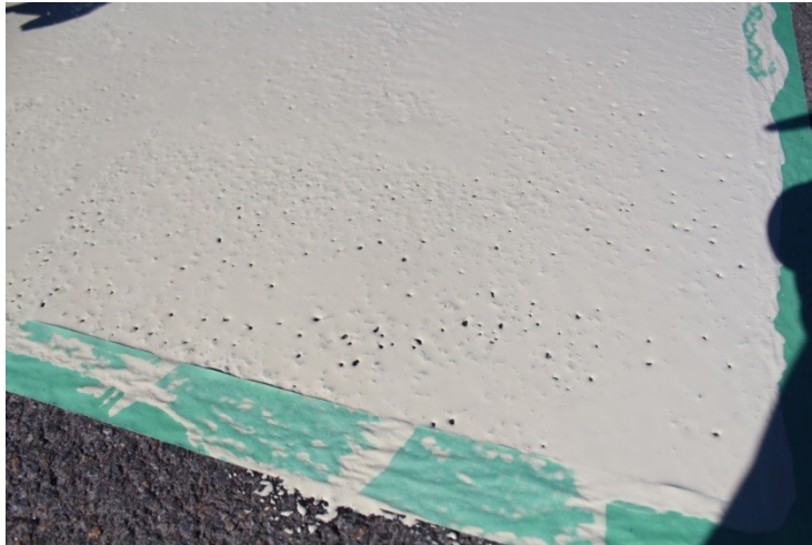
Figure A.16: Texture à la surface de la section A durant la cure
