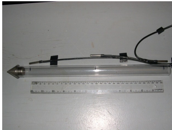
Figure A.6: Tube vide de polycarbonate avec thermistances aux positions approximatives où elles seront installées
