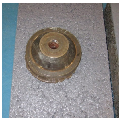
Figure 6.10: Rondelle métallique collée à l'époxy à la surface du PerfectCool M
