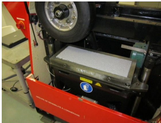
Figure 6.20: Échantillon de PerfectCool AP avant le début de l'essai à l'orniéreur
