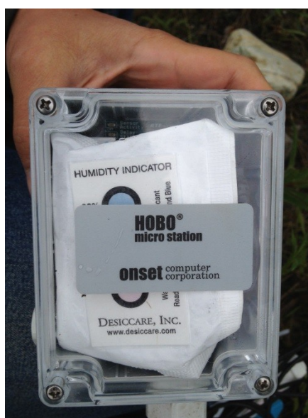
Figure 3.7: Enregistreur de données de marque HOBO micro-station utilisé à Beaver Creek (Photo : Benoît Loranger)
