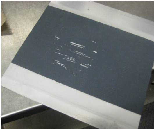
Figure 6.21: Plaque de PerfectCool A sans sable après 5 cycles
