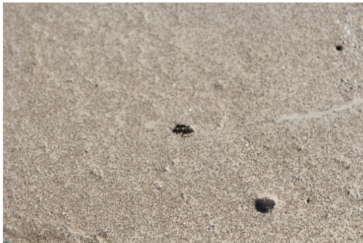
Figure A.17: Texture à la surface de la section G-0 durant la cure
