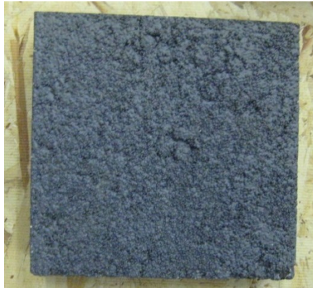
Figure 6.30: Échantillon de PerfectCool M après 72 cycles de gel et de dégel
