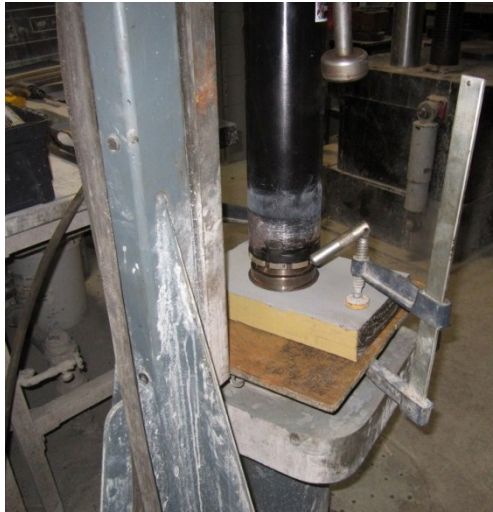
Figure 6.11: Carottage superficiel autour de la rondelle métallique
