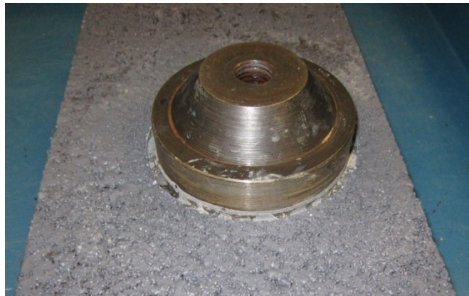
Figure 6.12: Échantillon de PerfectCool M suite au carottage superficiel
