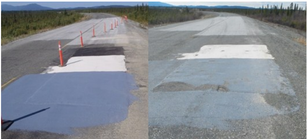
Figure 6.31 : État des surfaces, à gauche en 2012 suite à la mise en place de la planche expérimentale, à droite en mai 2013
