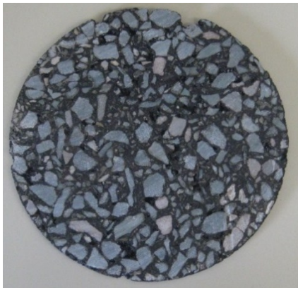
Figure 6.17: Type de support utilisé pour l'essai d'abrasion
