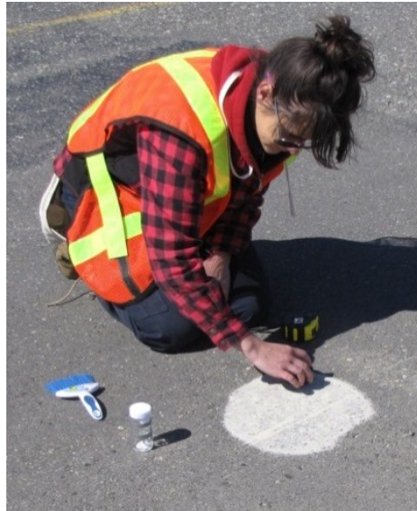
Figure 6.5: Essai de la tache de sable sur la surface d'enrobé froid à Beaver Creek en mai 2013
