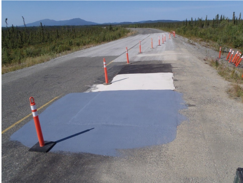
Figure 3.4: Planche d'essai complétée en août 2012, surfaces du bas vers le haut: Perfect Cool A - Nippo, Lafrentz, enrobé froid et traitement de surface à granulats clairs (L-BST) (Photo: Yukon Highways and Public Works)
