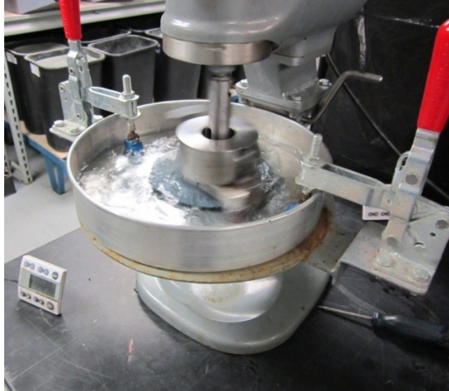
Figure 6.16: Essai de Wet Track Abrasion en cours
