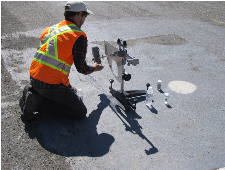
Figure 6.7: Essai de pendule britannique réalisé sur la surface de PerfectCool A
