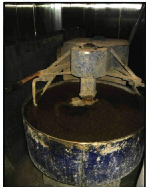
Figure 3.24 – Malaxage du béton
