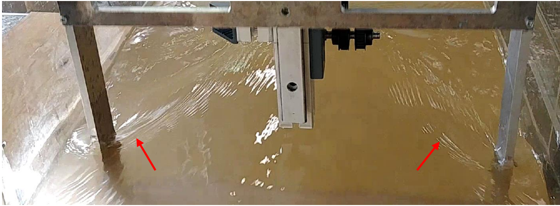
Figure 4.2: Photographie présentant une vue de devant du montage installé dans le canal de l'Institut de Mécanique des Fluides et des Solides lorsque celui-ci est en marche démontrant l'influence des bras verticaux supportant le cylindre amont sur l'écoulement.
